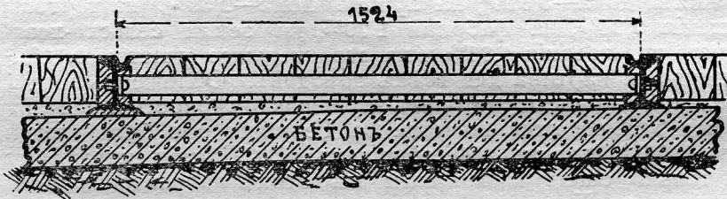
Рис. 8. Трамвайный путь на улицахъ съ бетоннымъ покровомъ. Варшава.
